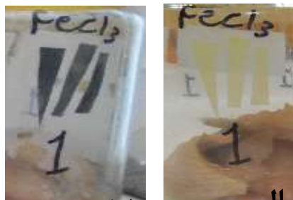
شکل ۴ تغییرات رنگ حسگرها طی دوره نگهداری در دمای ۲۵ درجه سانتی‌گراد به مدت ۳ روز (الف- نمونه تازه ب- نمونه فاسد شده پس از سه روز)
